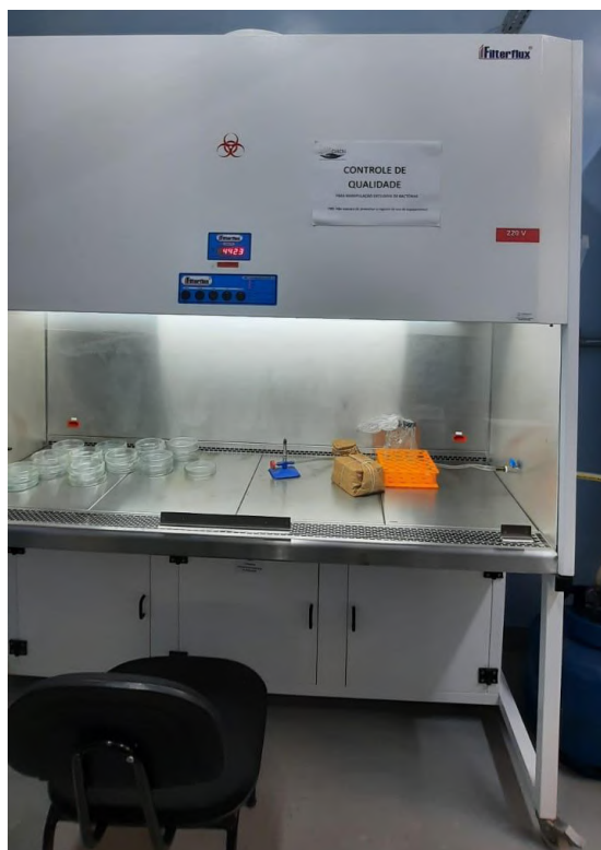
Figura 1 - Cabine de fluxo laminar, instalada no CVACBA
