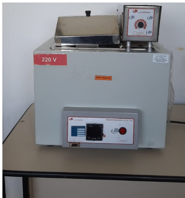
Figura 6 – Banho maria com agitação automática, instalado no CVACBA
