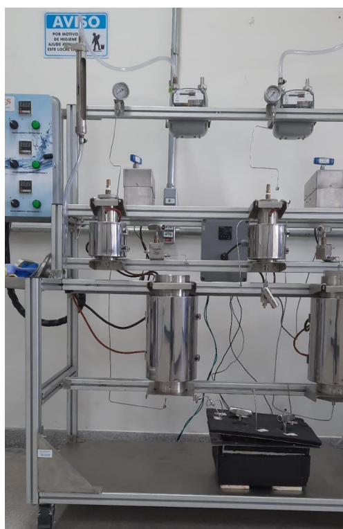
Figura 2 – Extrator supercrítica, instalado no LABTECS
