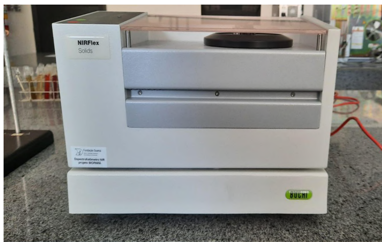
Figura 3 – Espectrofotômetro no infravermelho, instalado no LOA
